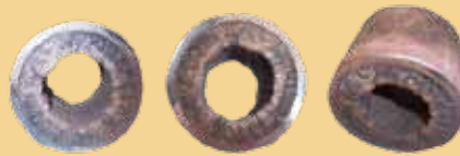
สภาพภายในท่อ ที่ถูกตะกรันจับ ทำให้ขนาดท่อลดลง
